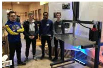
hydraulische Containerpresse. Darunter kann ein Container mit einer Fassung von 800 Litern untergeschoben werden und der Inhalt wird über einen Hydraulik-Zylinder gepresst. Das
