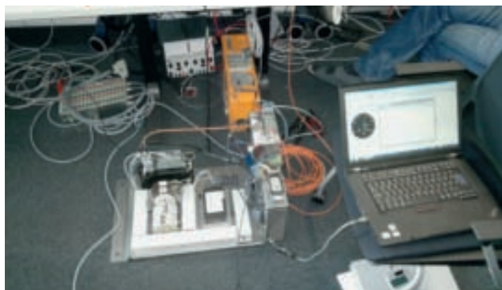
Ersttest in Zürich. Per Laptop und MVB werden die Signale des GPS-Sensors geprüft.
